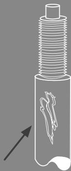
Ammortizzatore che presenta l'albero cromato con evidenti segni di graffiatura della superficie cromata, con conseguente perdita di olio e gas ogni qual volta la parte danneggiata entra nella guarnizione a tenuta di gomma. Danno causato dal non corretto impiego di utensili idonei al montaggio degli ammortizzatori.
